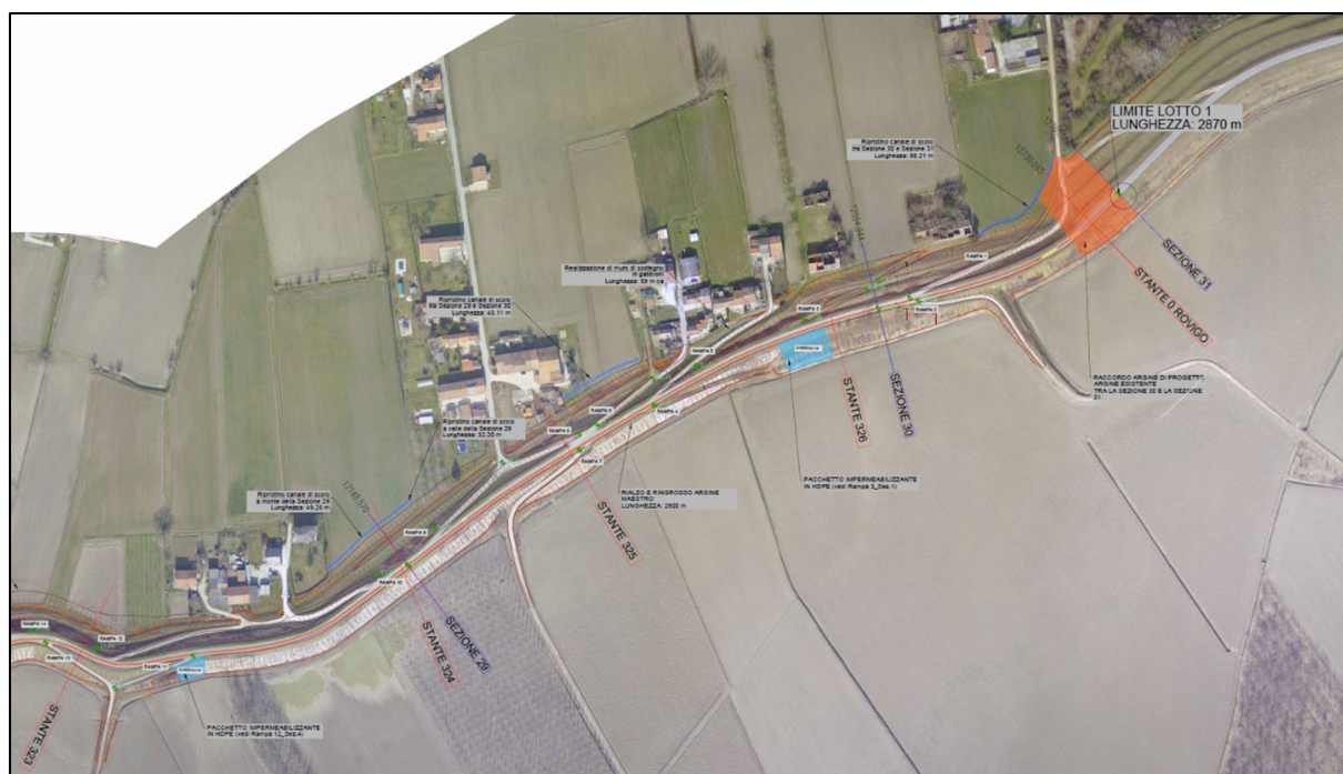
Figura 6 - Esempio di dettaglio planimetrico del rilevato arginale di progetto.
